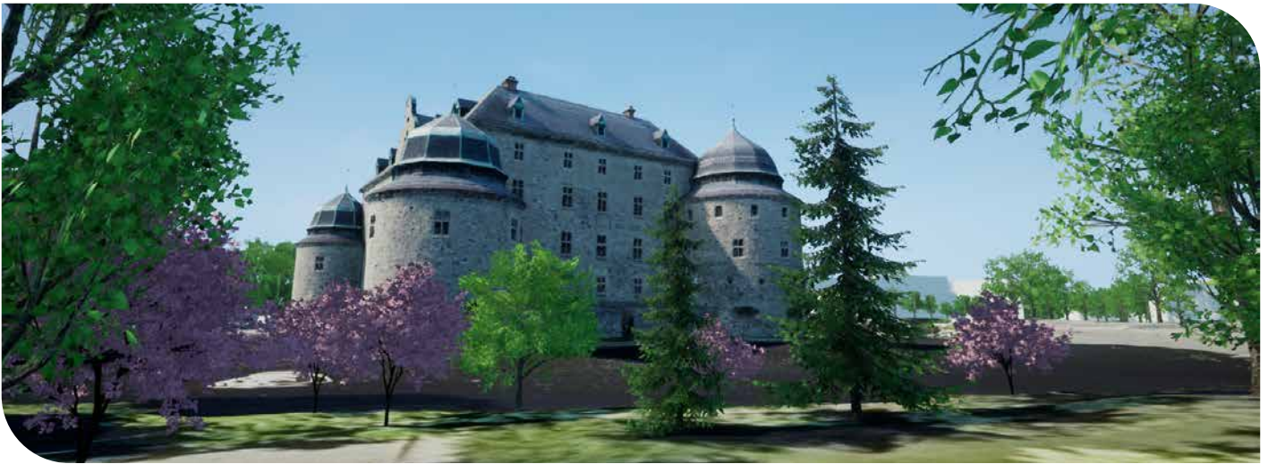
Fotogrammetrisk modell skapad med drönbilder – en del av Örebro digitala tvilling. Träden är genererade med hjälp av data från Örebro träd databas, där position, höjd och art använts för att välja passande trädmodell och skala den. Bild: Örebro kommun.
